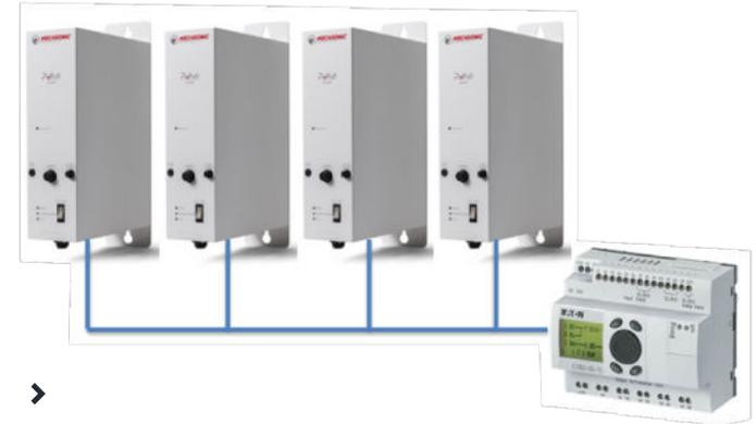
> Los generadores verticales Pulse One y Pulse Touch pueden conectarse en red a través de su interfaz RS422/485. Las conexiones RS422/485 se encuentran en el conector SubD25, pero también en el conector frontal de 12 pines.
