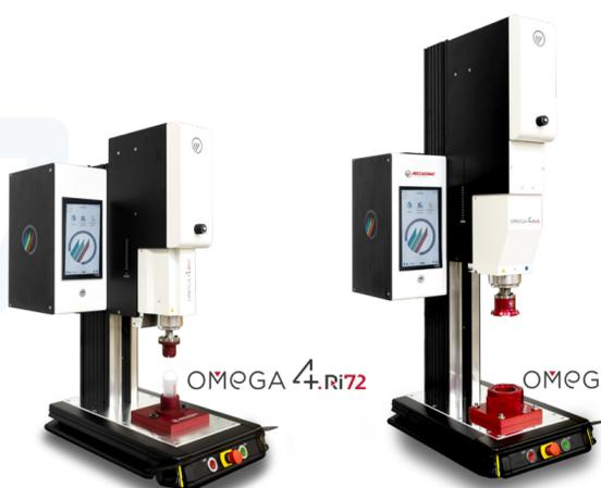
La solution idéale pour garantir une soudure parfaite sur les pièces de forme circulaire : des soudures étanches, hautement résistantes avec la possibilité d'une soudure indexée.
